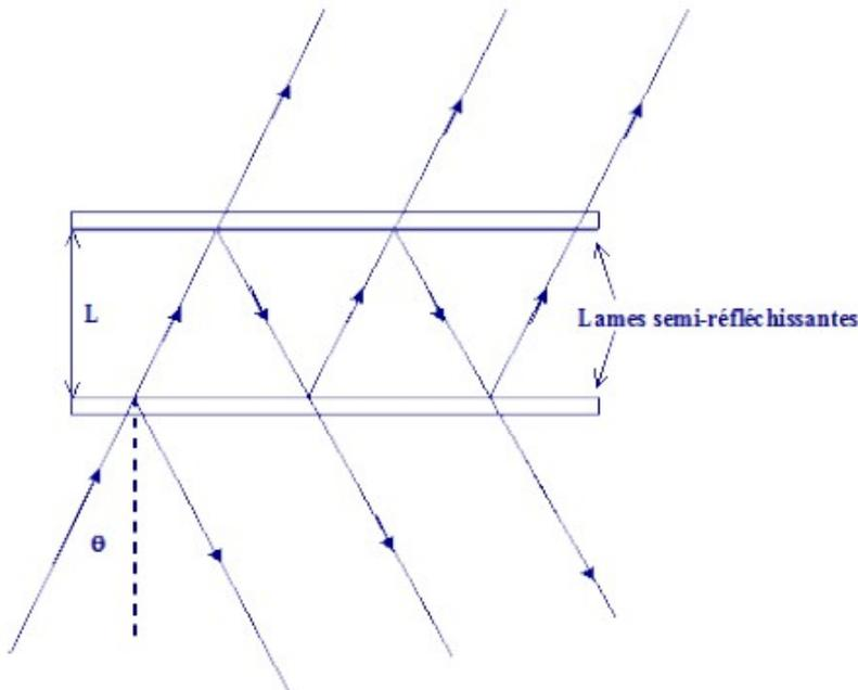
Un filtre interférentiel est constitué de deux lames semi-réfléchissantes parallèles séparées d'une distance  $L$  entre lesquelles se trouve un milieu transparent d'indice  $n$  qui peut être de l'air.
